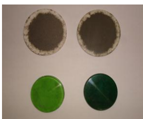
Figura 2. Fotografia de 02 amostras em forma de pastilhas (parte de cima) e 02 pérolas (abaixo). À esquerda teor de 2% de Cr 3+ e à direita teor de 7%.
