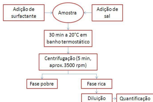
Figura 2. Esquema da extração utilizada. Condições otimizadas por planejamento fatorial: 2,5% (m/v) Triton X-114, 3,0% de NaCl, tempo de equilíbrio de 20 min e temperatura de 30°C.
